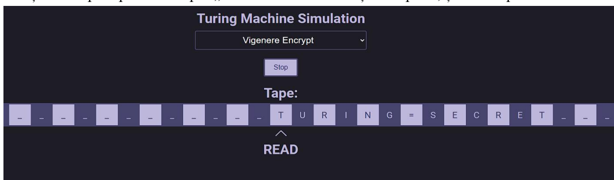
Figura 7. Simularea encriptării textului cu inputul inițial pe bandă
