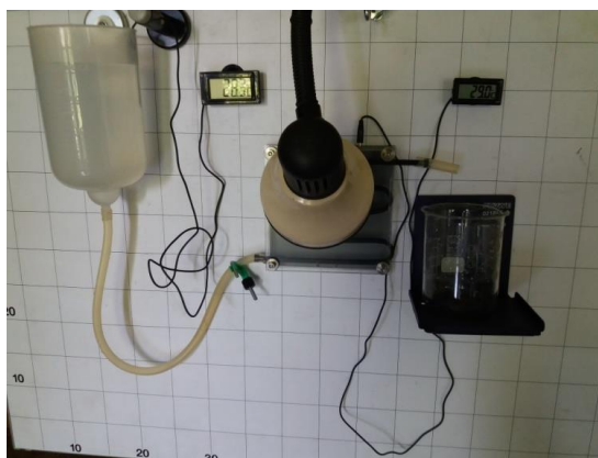
Figura 2. Realizarea experimentului. Încălzirea colectorului solar cu apă în stare dinamică
