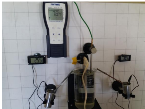
Figura 1. Realizarea experimentului pentru studiul transferului de căldură prin conducție în solide : fier și cupru
