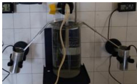
Figura 2. Realizarea gradientului de temperatură pentru barele de sticlă și aluminiu
